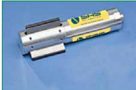
Der IDG greift und lässt auf Kommando los. Er wird für die Handhabung sowohl von zerbrechlichen, als auch von schweren Teilen empfohlen. Anders als bei Standard-Klemmen verteilt der Innengreifer die Kraft gleichmäßig über die ganze Kontaktfläche und begünstigt somit den Einsatz bei unregelmäßig geformten Teilen.
