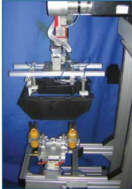
Drehbare Angusschneide-Station reduziert die erforderlichen Schneideinsätze
