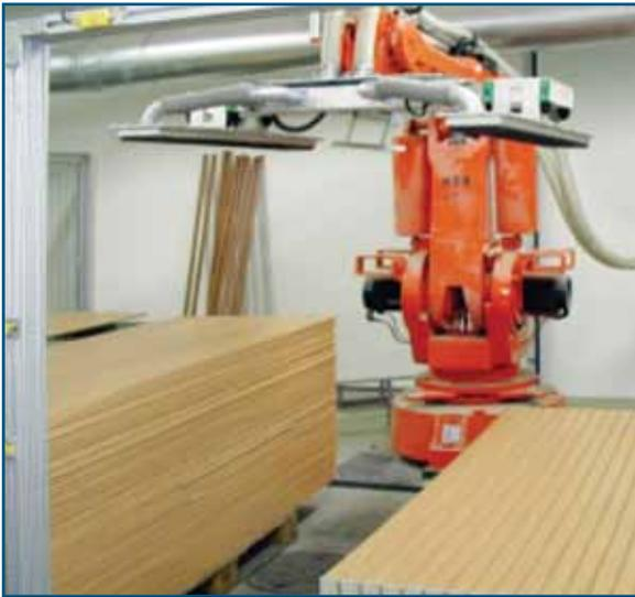
Dieses neue Hochleistungs-Vakuum-Handling-System ist ein Universalgreifer, der Lebensmittel, Bauteile, Paletten, Verpackungen und Zwischenlagen in verschiedenen Größen sicher handhaben kann.
