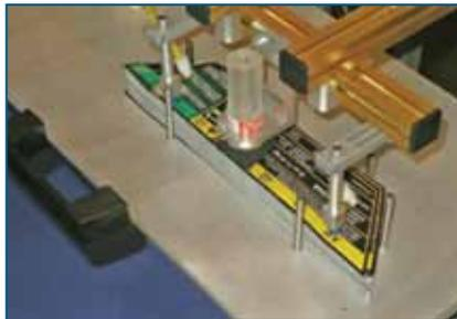
Beim IML werden Etiketten in die Form eingelegt, so dass diese mit dem fertigen Gussteil fest verbunden werden können. Wir haben ein IML-Verfahren entwickelt und patentieren lassen, bei dem das Etikett weder von der Form noch vom Greifer mechanisch erfaßt werden muss. Auf diese Weise ist die Oberfläche des fertigen Teils erheblich reiner.
