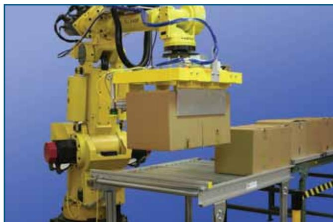
Roboter Greifer-Multifunktionsgreifer für Paletten und Kartons
