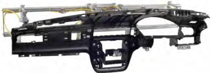
Roboter greifer für Armaturenbrett aus dem Automobilbau
