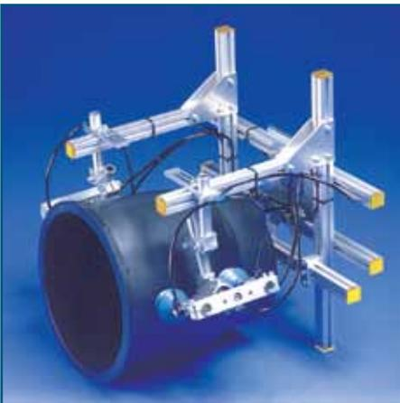
Montierter modularer Robotergreifer
